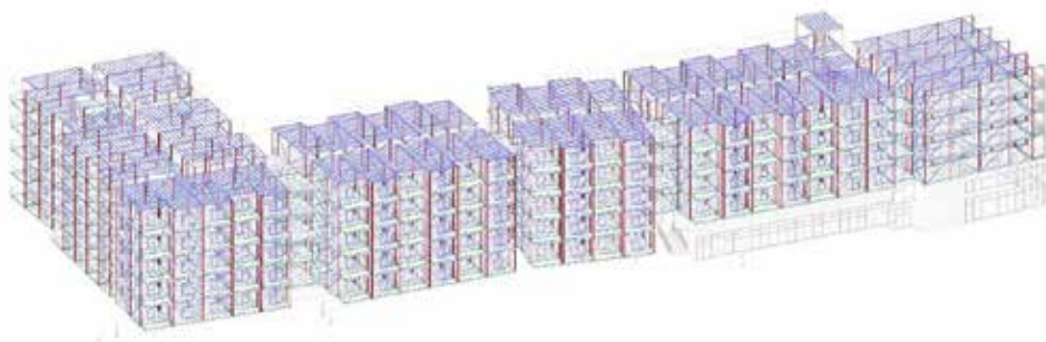
FIGURE 4 : Charpentes de modules intégrées au modèle maître
