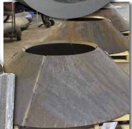
Formage de freins jusqu'à 20 po d'épaisseur
