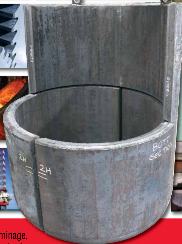
Formage de freins jusqu'à 20 po d'épaisseur
