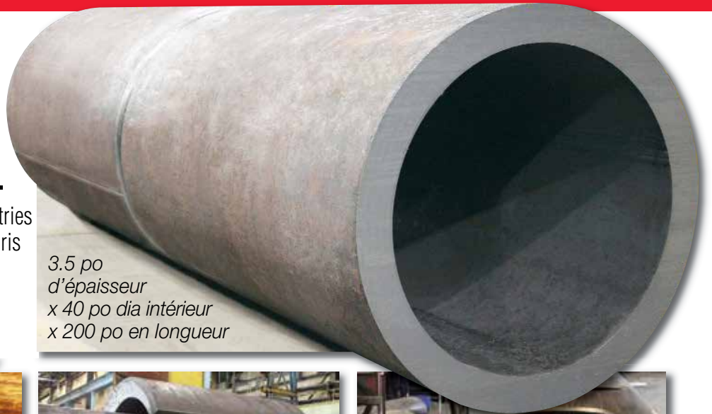
Laminage de plaques d'acier jusqu'à 10 po d'épaisseur
