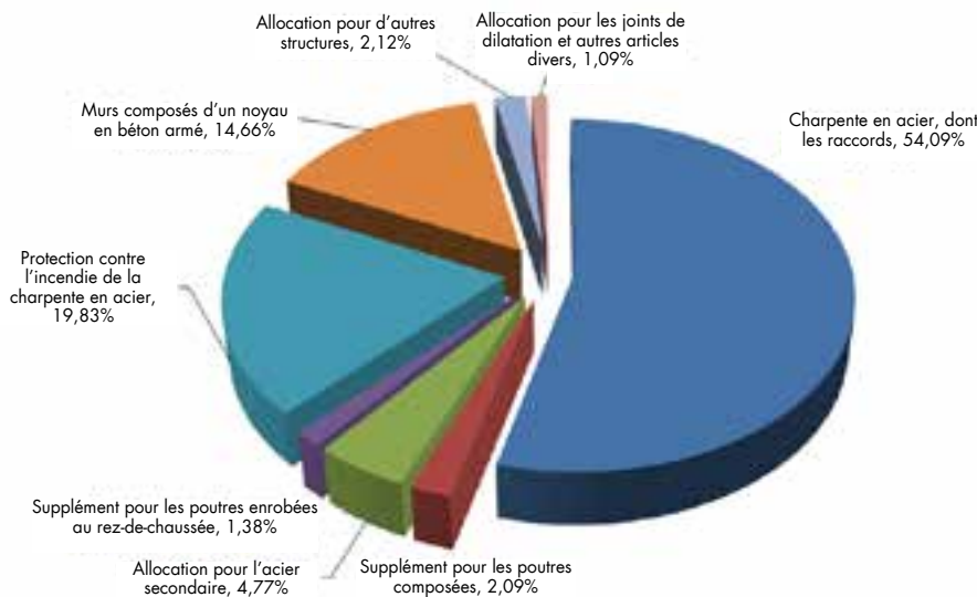
FIGURE 1: Exemple de ventilation des coûts relative au coût des composants de la charpente d'un immeuble de bureaux de 14 étages situé dans le centre de Londres (Building Magazine, 2011) montrant la proportion des coûts associés à la protection-incendie.
